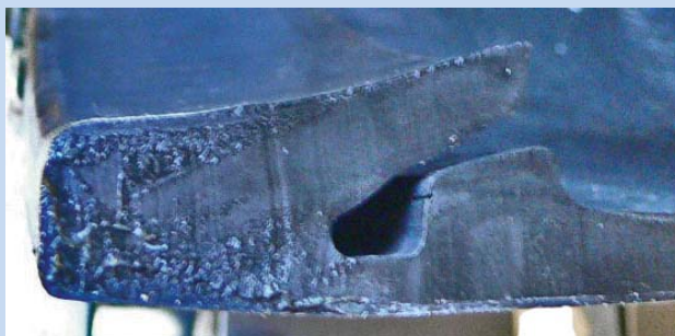
A közegnyomás hatására felnyíló és így a külső csőpalástra feszülő tömítés
